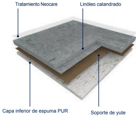
**Marmorette Acoustic Plus** es un revestimiento de suelo acústico de linóleo calandrado en plancha, de 2 m de ancho, que proporciona una excelente resistencia al desgaste diario en zonas de mucho tránsito.
