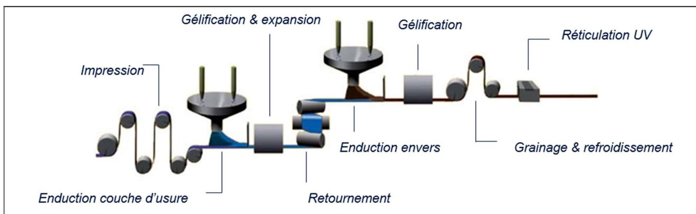
Figure 1 : Process d'Enduction
