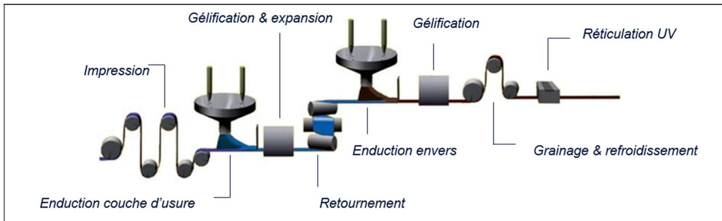
Figure 1 : Process d'Enduction
